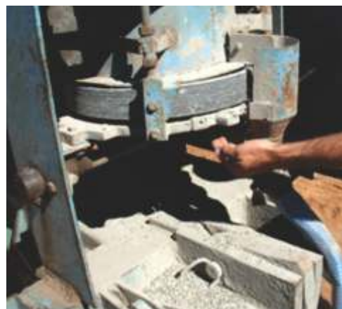
Figura 1. Vazamento de adubo em adubadora com sistema de prato.
