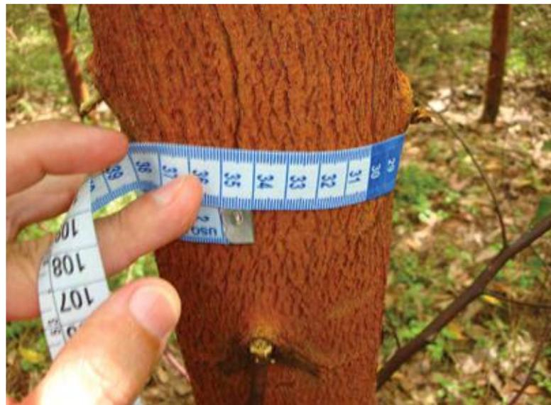
**Figura 6.** Medição do CAP (cm) de uma das plantas apresentadas na **Figura 5**.
