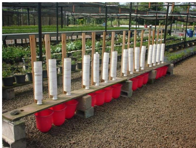
**Figura 2.** Tubos contendo solo (RQo2) fixados com arame em estacas e apoiados pela redução em duas tábuas de 3 metros cada, com seus respectivos baldes para coleta da água drenada.
